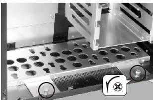
Lösen Sie die Rändelschrauben, um das 2.5-Zoll-/3.5-Zoll-Festplatten-Einbauteil zu entfernen.
