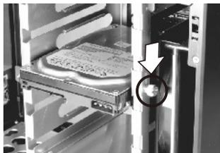
Schließen Sie die Klappe, um die Festplatte zu verschließen.
