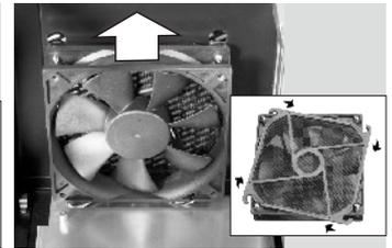
Schieben Sie die vibrationsdämpfenden Lüftermodule zur Seite, um sie entfernen.
