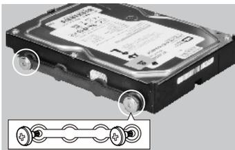
Befestigen Sie Schrauben mit vibrationsdämpfenden Gummiringen an der Festplatte.
