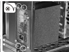
Befestigen Sie es mit vier Rändelschrauben am Gehäuse.
