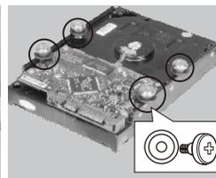
Befestigen Sie Schrauben mit vibrationsdämpfenden Gummiringen an der 3.5-Zoll-Festplatte.
