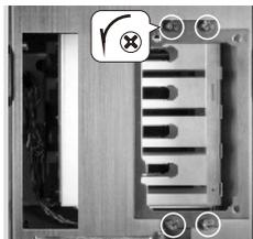
Lösen Sie vier Rändelschrauben, um das PSU-Befestigungsteil zu entfernen.
