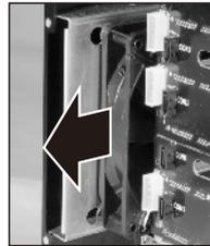
Schieben Sie die vibrationsdämpfenden Lüftermodule zur Seite, um sie entfernen.
