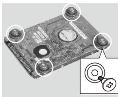
Befestigen Sie Schrauben mit vibrationsdämpfenden Gummiringen an der Festplatte.
