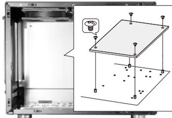
Legen Sie das Motherboard auf die Abstandsbolzen und befestigen Sie es mit Schrauben.
