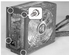
Montieren Sie das Netzteil am PSU-Befestigungsteil.
